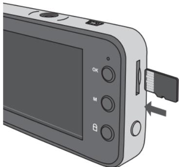
microSD/SDHC カードを抜き差しする時は、必ず電源が入っていないことを確認してください。
